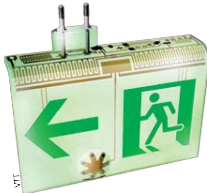
Opastekylyn joustavalle kalvolle on painettu elektroniikkapiirit, valoa tuottava pinnoite sekä sensori. Kalvon komponentit on suojattu ruiskuvalulla.
